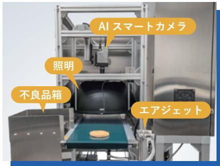
照明の明るさ、ピントずれ、対象物の向きなど、正確な検査に欠かせない撮像部分にも配慮した設計で、すぐに検査を始められる製品です。
