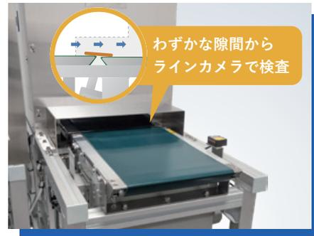
反転ユニットや裏面検査用に別の検査装置を準備しなくても、これ1台で表裏同時検査が可能な検査ユニットを搭載しました。
